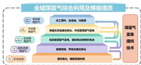
图15 全域煤层气综合利用及梯级提质示意图
